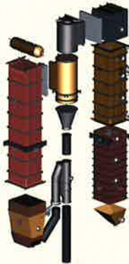
小型CFBボイラの分割(モジュール化)
